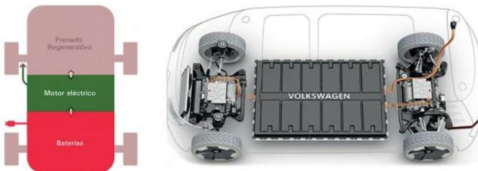
**Figura 3.** Componentes de vehículo eléctrico.
