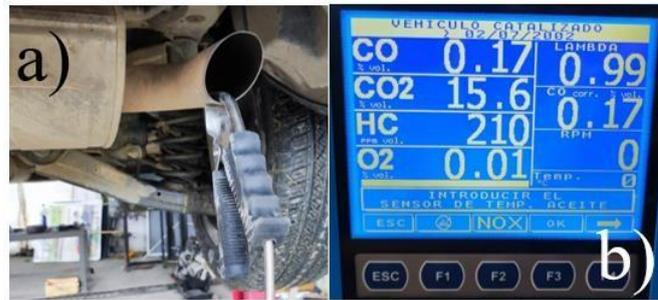
Nota: a) sonda conectada al tubo de escape b) pantalla del analizador de gases
