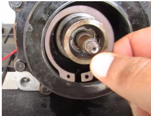
Fig.8. Extracción de bobina
