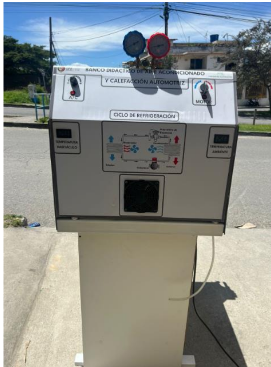
Fig. 2. Tablero de selección de modos (vista frontal del banco)
