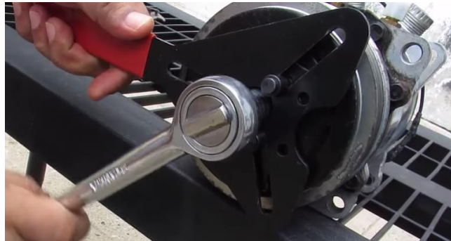
Fig.5. Extracción de la tuerca de sujeción
