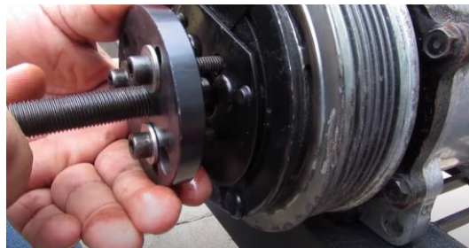
Fig.6. Extracción del embrague
