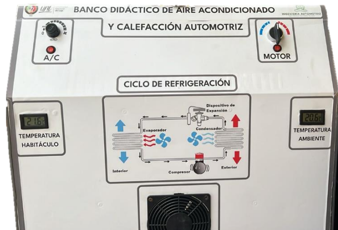
Fig. 4. Centro de mandos del banco didáctico de aire acondicionado y calefacción automotriz
