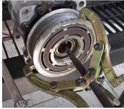
Fig.7. Extracción de polea
