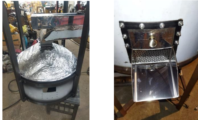
Figura 17. Montaje de Compuerta y Forrado del Sistema Calentador
