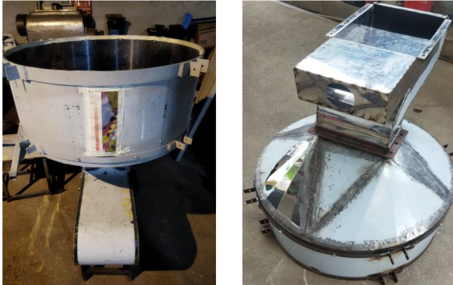
Figura 15. Montaje y Construcción del Sistema de Ductos de Aire
