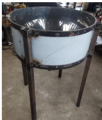
Figura 14. Construcción y Montaje de la Estructura de Soporte del Prototipo Secador
