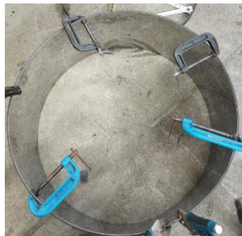
Figura 11. Rolado de la Cama Principal
