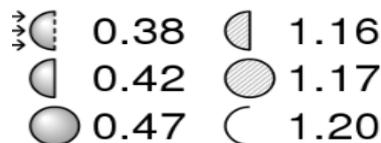
**Figura 27:** Coeficientes de forma para algunas geometrías.
