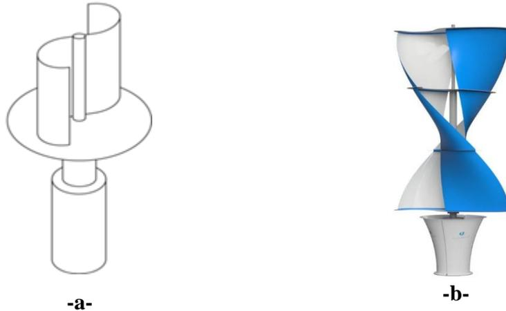
**Figura 2:** Turbina Savonius, a) con álabes semicilíndricos, b) con álabes helicoidales.
