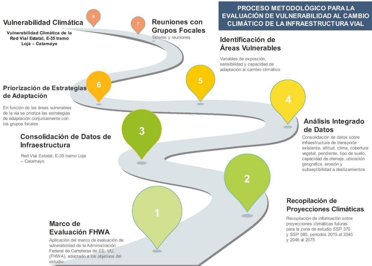
Figura 5. Marco metodológico para la vulnerabilidad de infraestructura vial.
