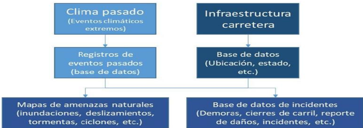
Figura 2. Esquema para la determinación de impactos del cambio climático en la infraestructura carretera en México. (Mendoza-Sánchez et al., 2019)
