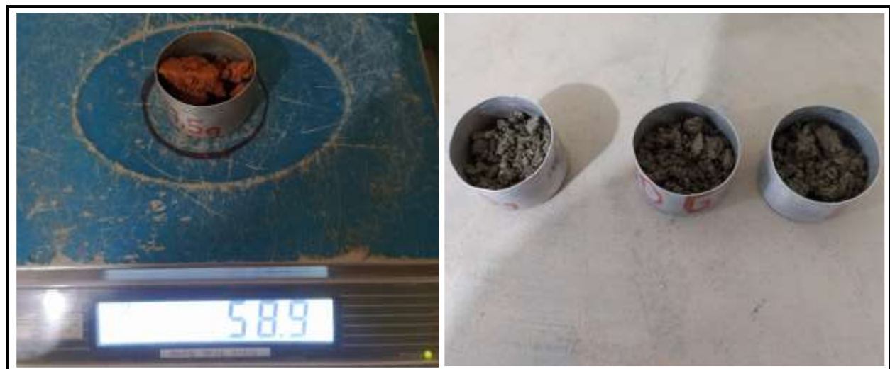
Anexo 2. Ensayo de contenido de humedad.
