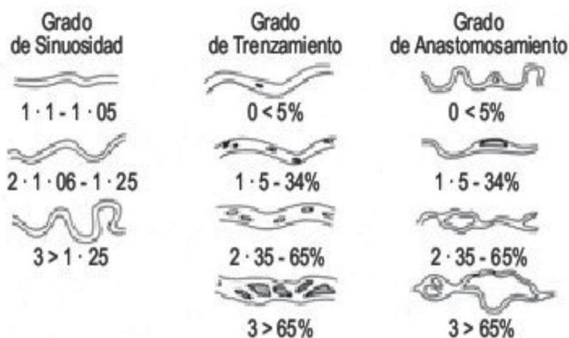
Figura 10. Clasificación de canales fluviales
