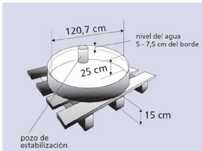
Figura 6. Características del tanque evaporímetro tipo A.
