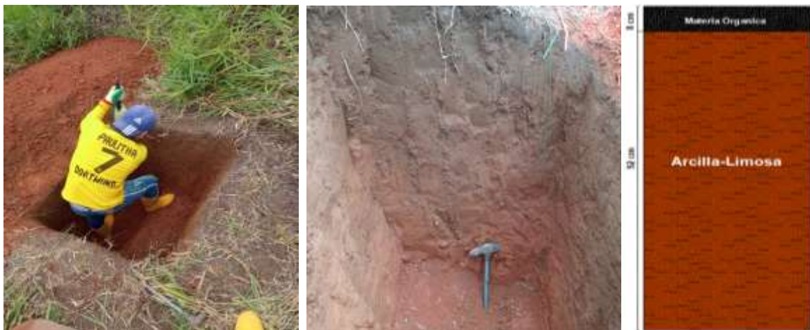
Figura 46 Calicata Geológica 1 y perfil estratigráfico
