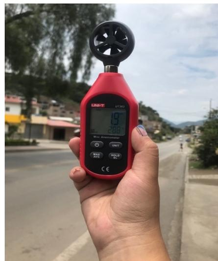
**Figura 11.** Anemómetro para medir la velocidad del viento.
