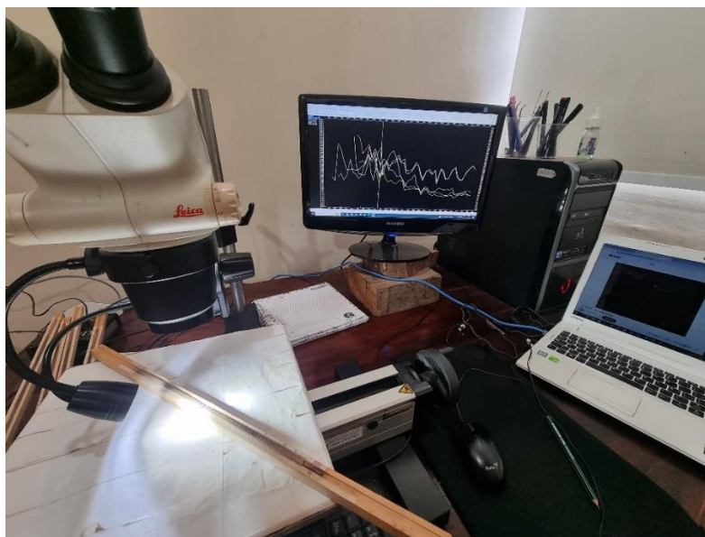
Figura 9: Medición de anillos de crecimiento de un núcleo de madera de Juglans neotropica con el sistema Lintab Pro 6 del Laboratorio de Dendrocronología de la Universidad Nacional de Loja.
