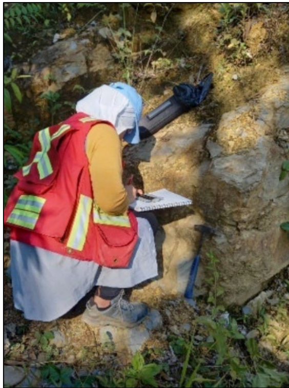
Figura. 33. Trabajo en campo de resistencia a la compresión simple con esclerómetro
