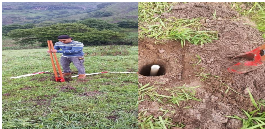
Figura 19 Excavación para determinar la permeabilidad
