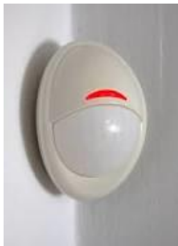
Figura 23. Sensor de movimiento
