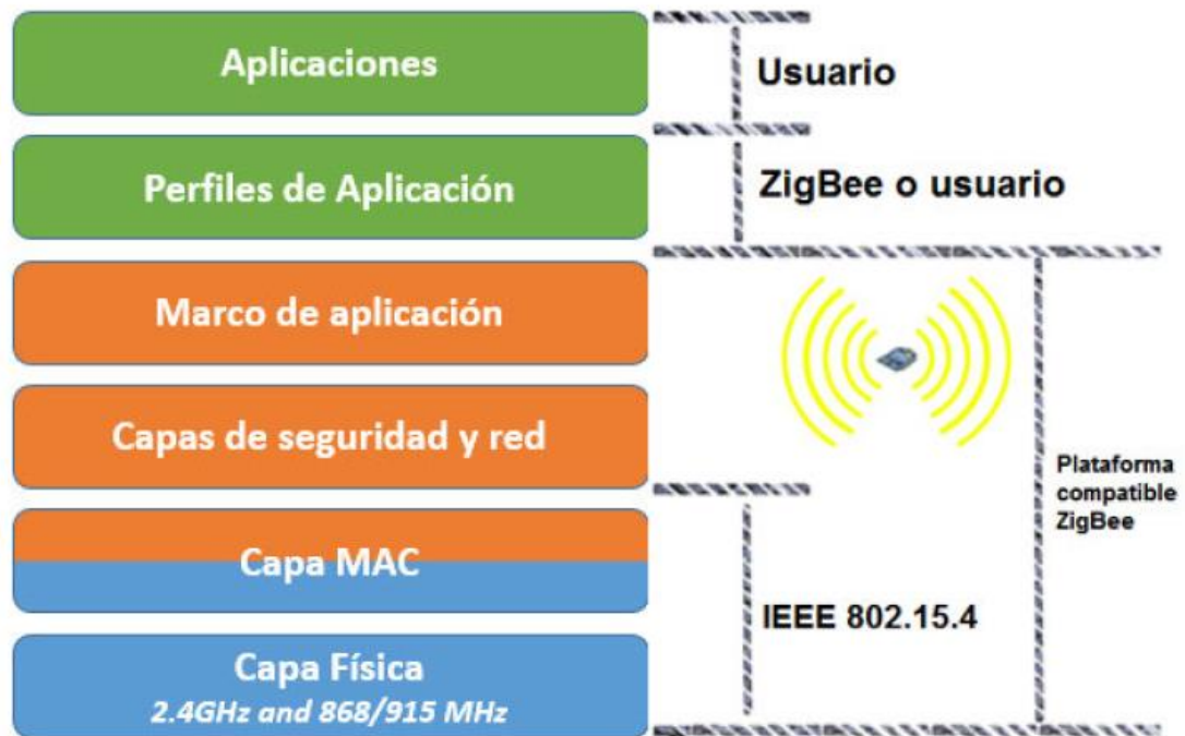
Figura 6. Estructura en Niveles de Zigbee
