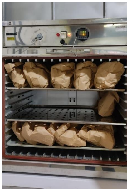
Anexo 10. Figura 11. Determinación del contenido de materia seca mediante secado en estufa.
