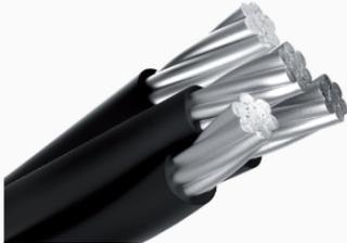
Los cables preensamblados para circuitos de baja tensión son construidos a partir de la reunión de 1, 2 o conductores de fase aislados alrededor de 1 conductor neutro aislado. Son utilizados en circuitos de distribución y acometidas domiciliarias. Proporciona una mayor confiabilidad al sistema eléctrico, evitando desconexiones debido a cortocircuitos.
