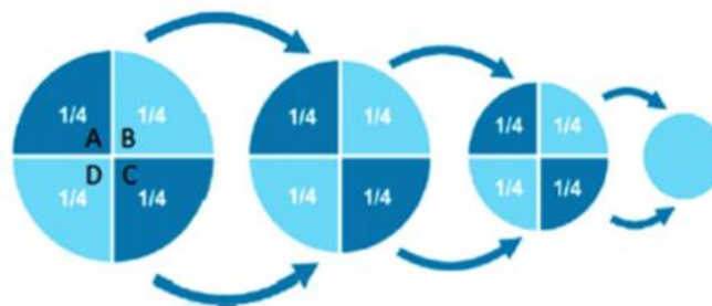
Figura 2. Método del cuarteo, (Guerrero et al., 2021).
