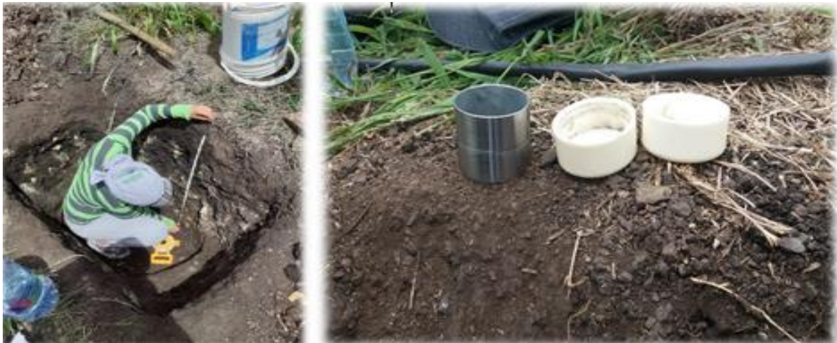
Figura 14. Obtención de las muestras inalteradas.
