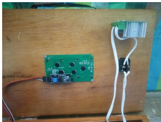
Conexiones de pantallas LCD a Arduino mega 2560 y regulador de temperatura del sistema emulador de calor (Dimmer de voltaje).
