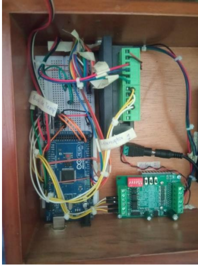
Conexiones del hardware del sistema de control de temperatura, TB6600, modulo SD cards, sondas de temperatura, fin de carreras.
