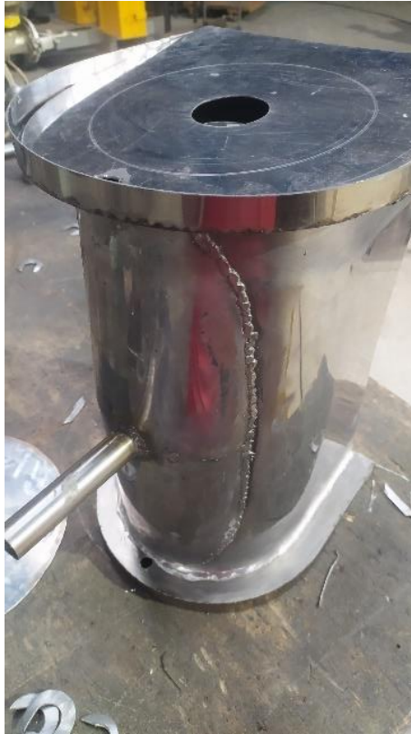
Figura 92. Proceso de ensamble del depósito.
