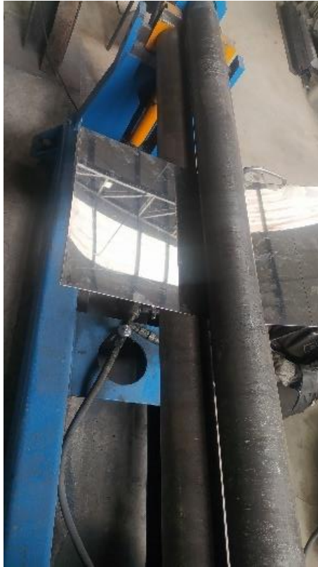
Figura 88. Proceso de rolado de planchas del depósito.
