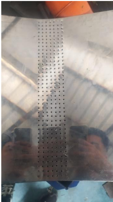
Figura 87. Plancha interna del depósito.
