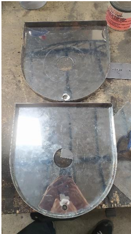
Figura 91. Cubierta frontal/trasera del depósito.
