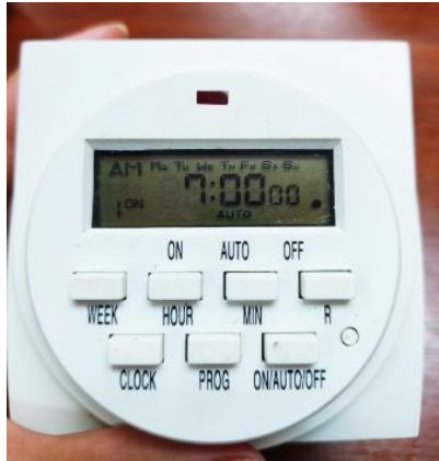
Programación del temporizador digital según los ciclos de riego establecidos
