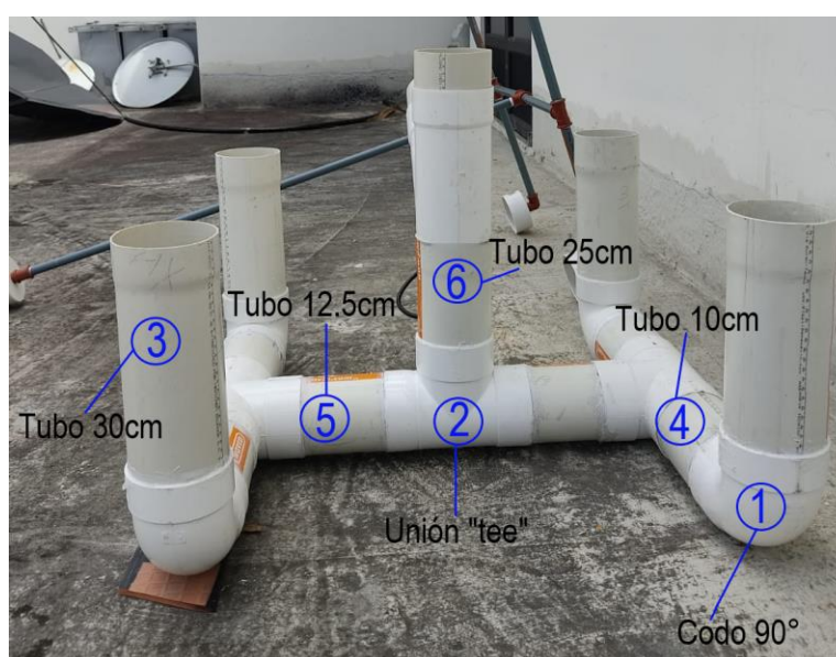
Figura 46. Elementos que conforman la base del cultivo hidropónico.
