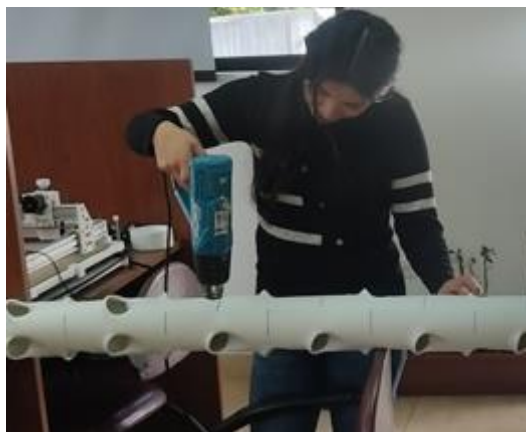
Calentar el área de la tubería para realizar los orificios
