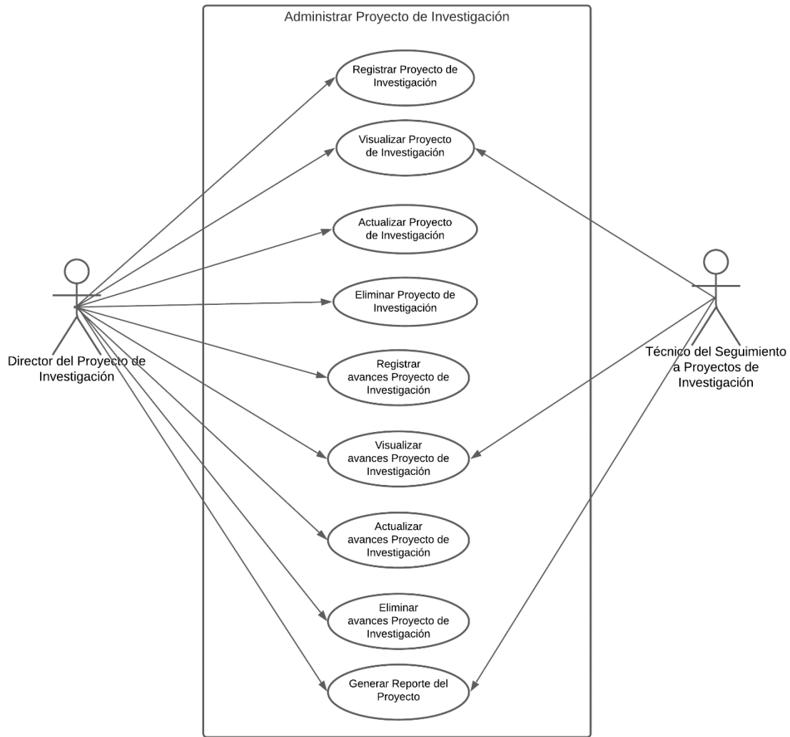
Figura A8 4. Diagrama de Caso de Uso Específico Administrar Proyectos de Investigación (fuente propia).
