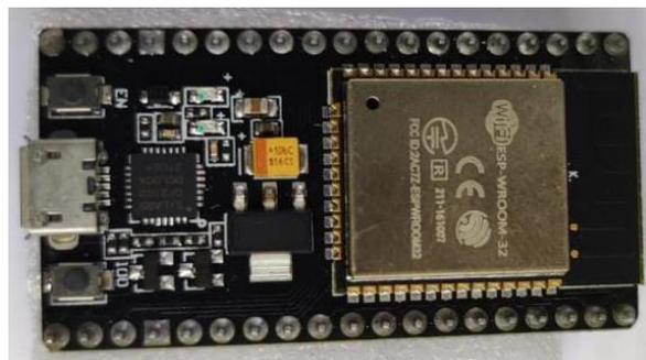
**Figura 22.** Módulo ESP32.
