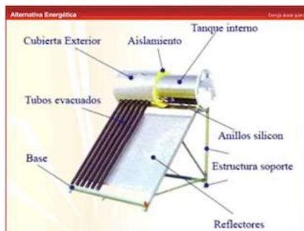
**Figura 3.** Partes de un calentador solar de tubos al vacío.
