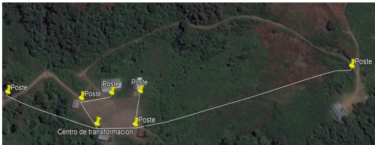
Figura 19. Red secundaria aérea en el sector rural, dentro del área de suministro DIMS CENTROSUR
