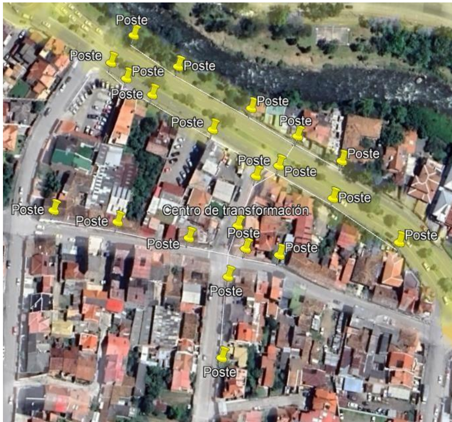
Figura 16. Red secundaria aérea en el sector urbano, dentro del área de suministro de la subestación SE-02 CENTROSUR-Cuenca.
