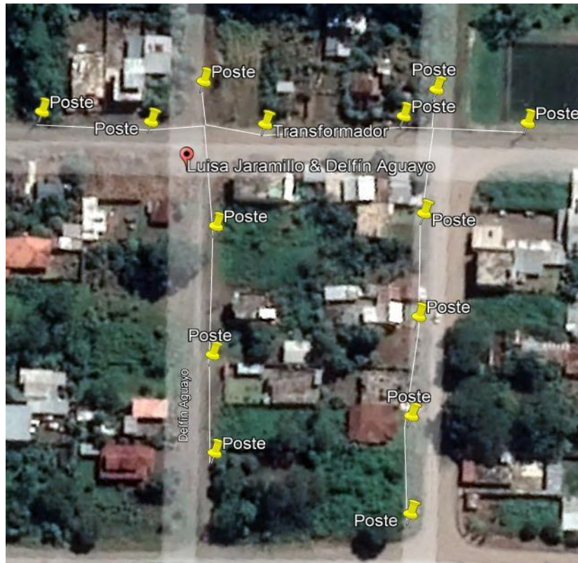
Figura 18. Red secundaria aérea en el sector urbano, dentro del área de suministro DIMS CENTROSUR- Macas
