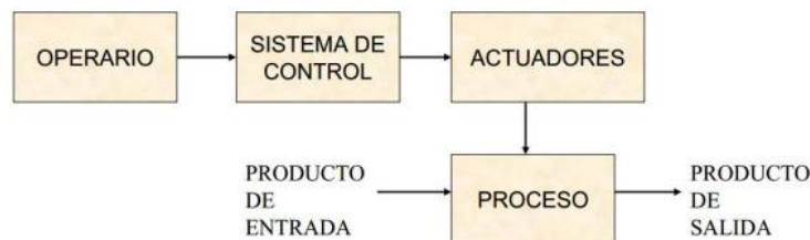
Figura 6. Diagrama esquemático de un sistema de control en lazo abierto.
