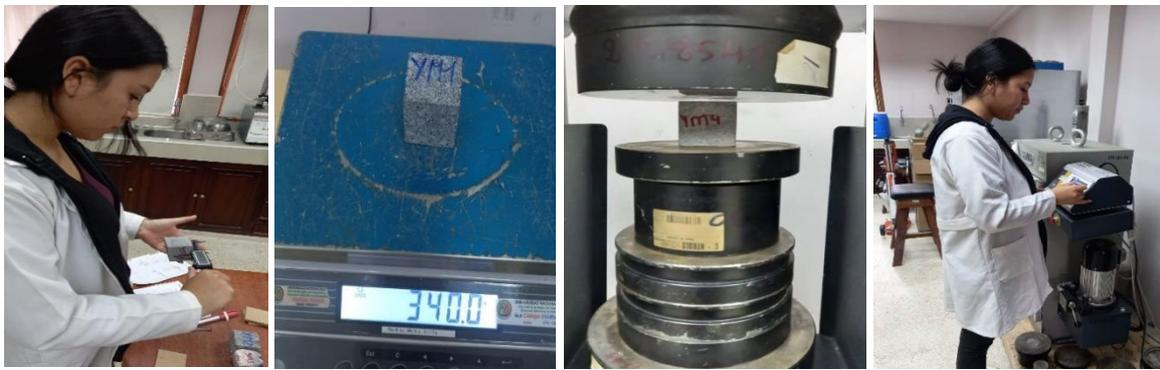
**Figura 8.** Procedimiento para realizar el ensayo de compresión
