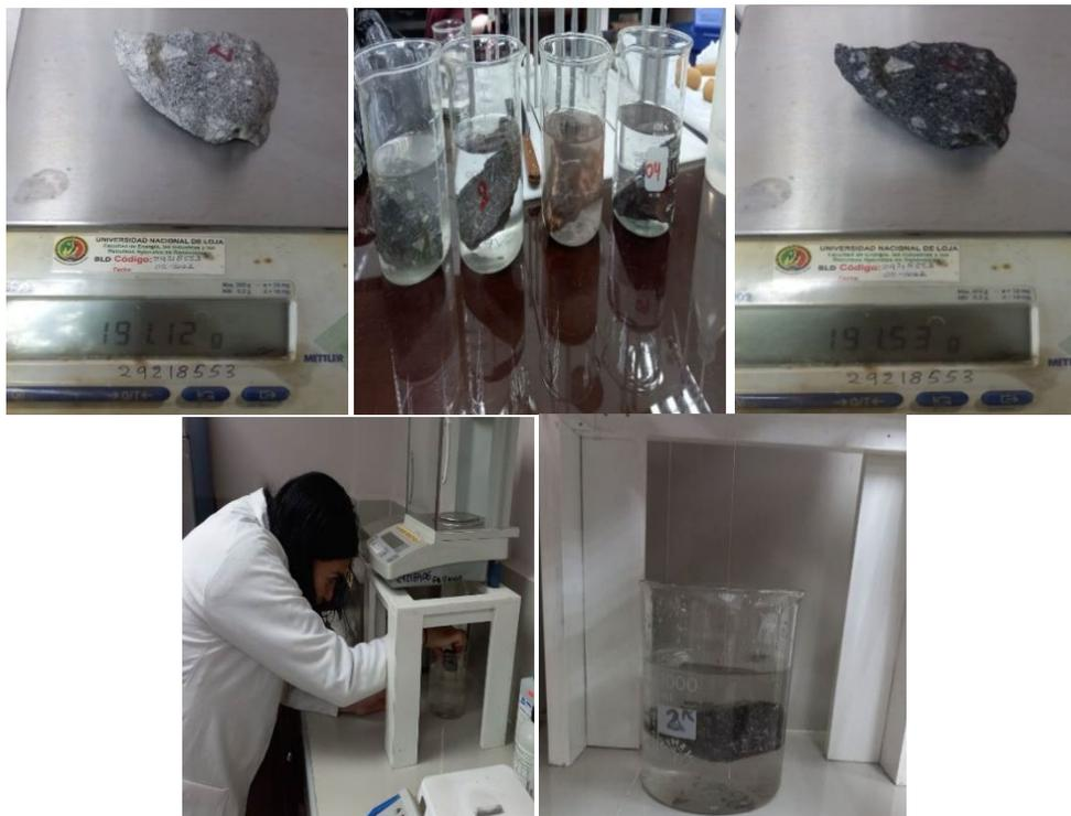
**Figura 6.** Procedimiento para determinar el peso específico aparente.
