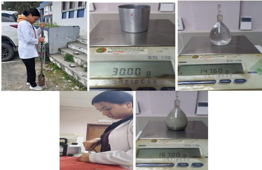
**Figura 7.** Procedimiento para determinar el peso específico real.
