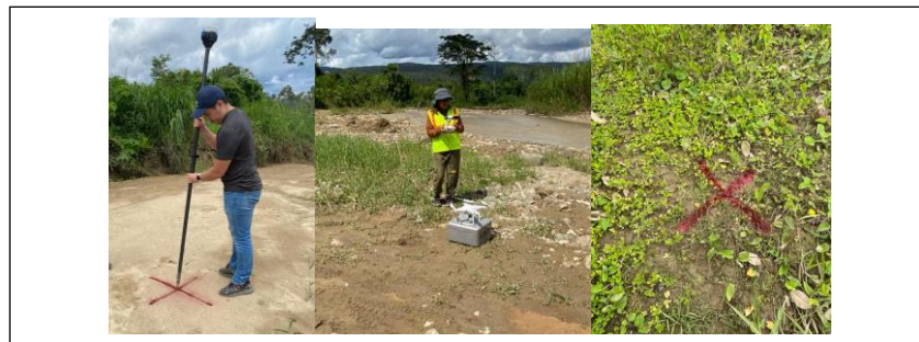
Figura 3. Posicionamiento del Punto Principal y puntos de control Nota: Fotografía tomada por la Autora.
