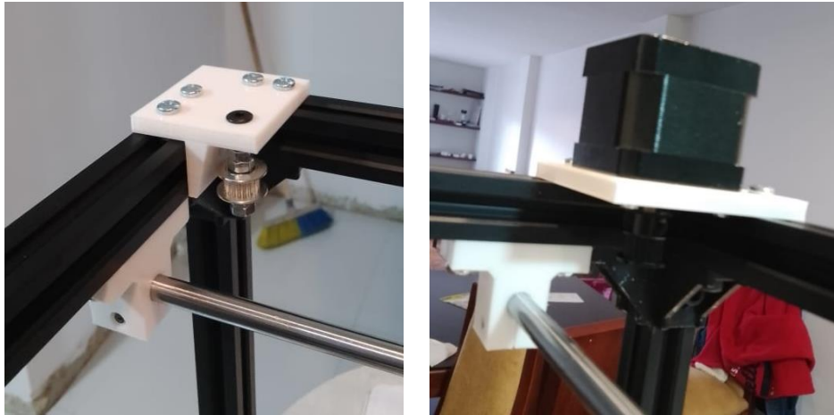
Figura 110. Montaje de motor (con su respectiva polea dentada) y polea dentada a la estructura.
