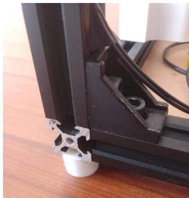
Figura 53. Unión de perfiles mediante soportes de esquina.
