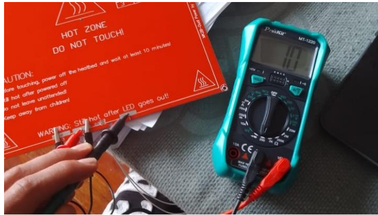
Figura 82. Medición de resistencia de la PCB MK2b.
