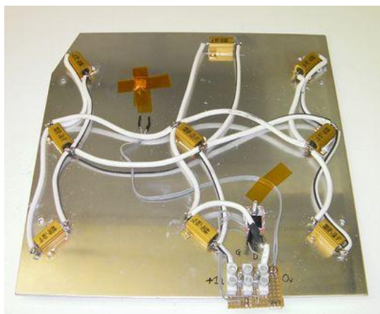
Figura 20. Base calefactada mediante resistencias cerámicas.
