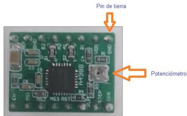
Figura 45. Driver A4988 y pines para medir Vref.
