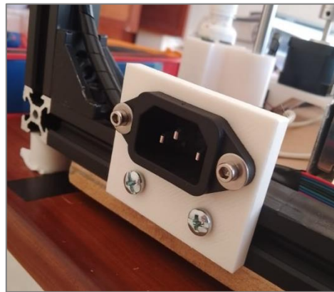
Figura 131. Soporte de enchufe impreso en PLA con la impresora desarrollada.
