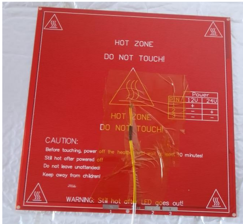
Figura 81. Cama caliente MK2b junto con termistor fijado con cinta kapton.
