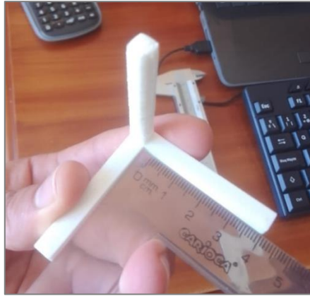
Figura 130. Verificación de ortogonalidad en pieza impresa.
