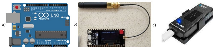
Figura 23. Módulo Tx y Gateway. Fuente: Elaboración propia.
