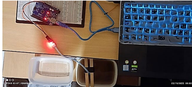
Figura 34. Calibración del sensor de turbidez. Fuente: Elaboración propia.
