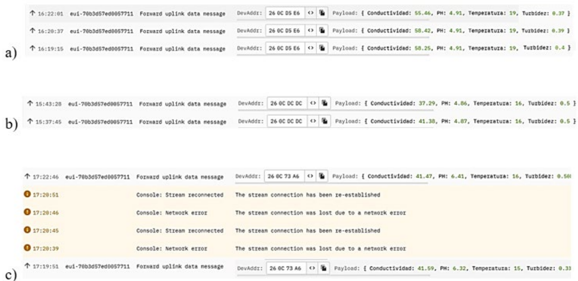
Figura 64. Visualización de la pérdida de paquetes en el servidor TTN. Fuente: Elaboración propia.
