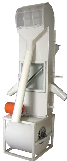
Figura 3. Máquina densimétrica tipo columna. Fuente: (Solocafé, 2023).
