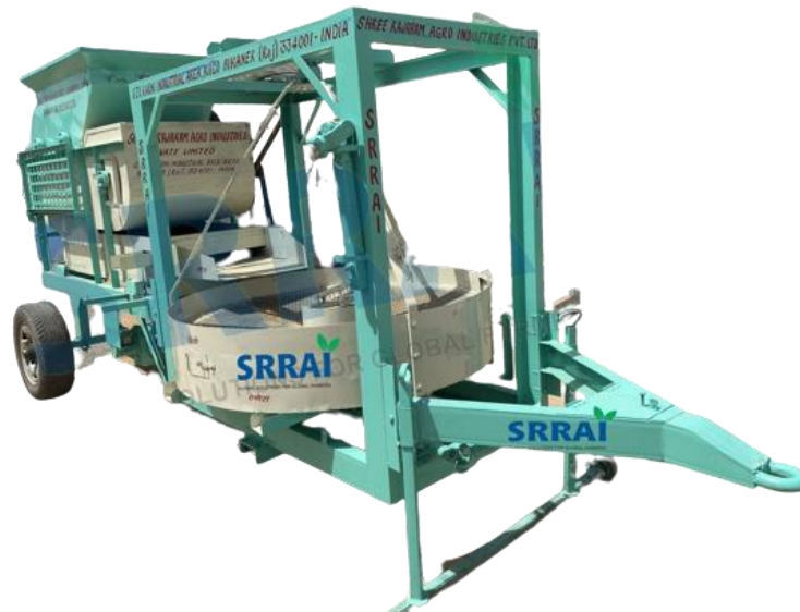
Figura 2. Máquina densimétrica tipo circular. Fuente: (Indiamart, 2022).
