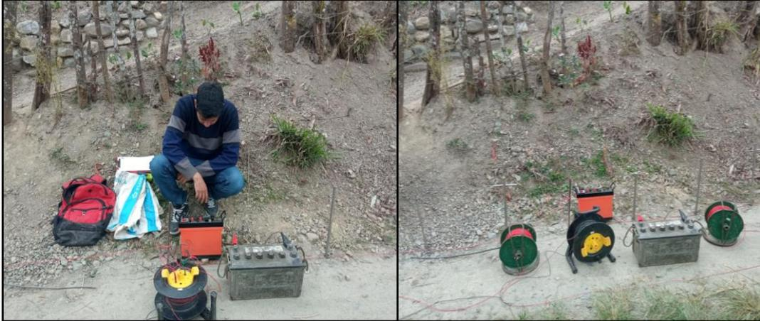
Una parte del tratamiento de los datos se la realizó en campo con el cálculo de la resistividad aparente con el uso de fórmulas y a su vez la elaboración de la curva resistividad – distancia sobre una hoja logarítmica, en donde las resistividades aparentes corresponden al eje de las ordenadas y las distancias en el eje de las abscisas.
