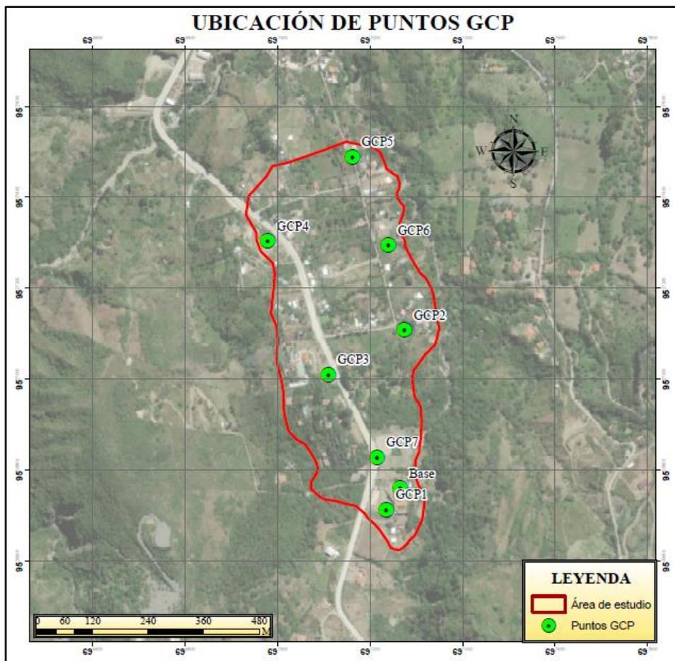
En total se realizaron 9 líneas de vuelo que fueron realizadas de forma automática por la aplicación de libre acceso (PIX4DCAPTURE) previamente cargada la información del sector con un total de 973 fotografías, delimitado y abarcando una extensión adicional en las afueras del área prevista esto para realizar un correcto traslape (80%) de las fotografías. Finalmente,
