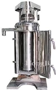
**Actividad:** Esta máquina nos permite separar los sólidos de líquidos a través de un movimiento circular a través de barandillas y filtros.
