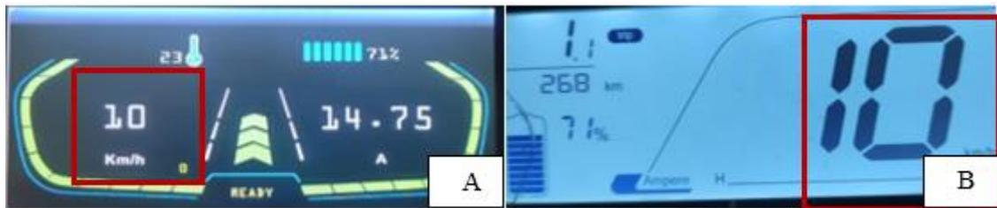
*Nota:* La sección A es la visualización a tiempo real en la pantalla Nextion y la sección B es la visualización en el panel de instrumentos original.
