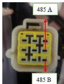
Nota: Cable verde/rojo para 485 A y cable verde/negro para 485 B. Los demás cables pertenecen al circuito de iluminación para los testigos luminosos en el panel de instrumentos.
