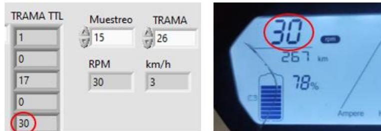
De esta forma se da condiciones en el diagrama de bloques como se aprecia en la **Figura 50**, ya que al superar las 256 revoluciones la información del valor agregado se escribe en un nuevo espacio.
