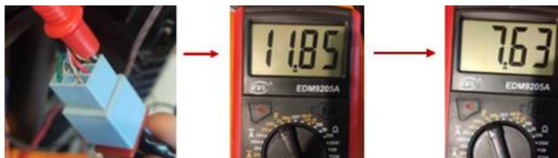
Como se puede observar, estos cables contenían una señal de 12V aproximadamente y de forma intermitente. Sin embargo, para que esta señal sea interceptada por medio de Arduino, el voltaje debía de ser menor o igual a 7V, para que la placa no se sobrecargue. Disminuir el voltaje de entrada se lo hace por medio de un circuito de resistencias.
