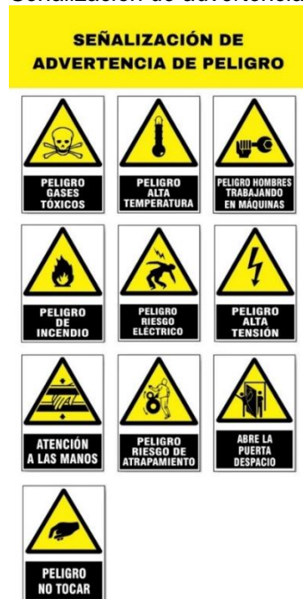
Figura 19 Señalización de advertencia de peligro
