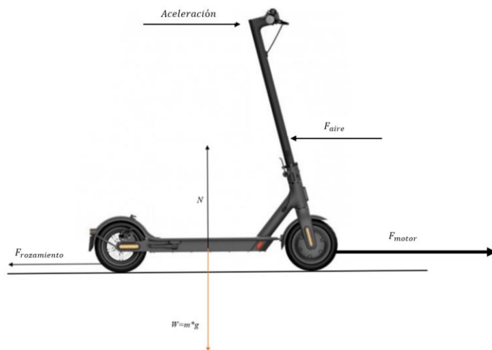
Figura 20. Diagrama de cuerpo libre del patinete.
