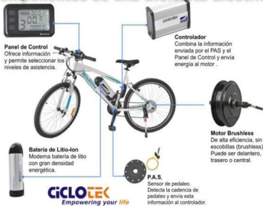
Figura 15. Componentes de una bicicleta eléctrica (GlobeTEK, 2010).
