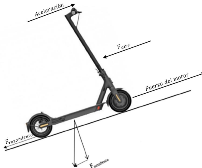
Figura 17. Diagrama de cuerpo libre del patinete.
