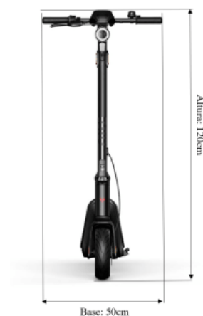
Figura 18. Área frontal del patinete eléctrico.
