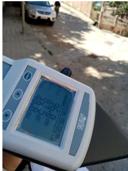
Medida de 83,5 (mal estado de vía)
