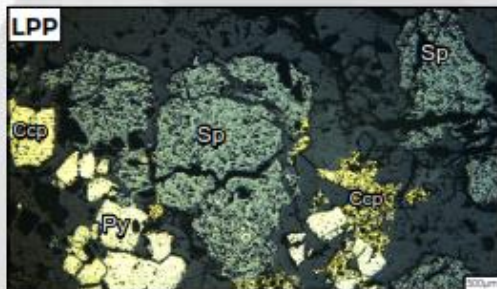
Descripción: Cristales de esfalerita con fracturas, se aprecian cristales de pirita aislados y calcopirita asociada a pirita.
