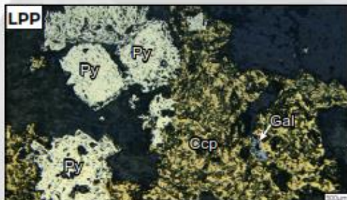
Descripción: Cristal de calcopirita junto a cristales de pirita cúbica. Al interior de la calcopirita se observa galena.
