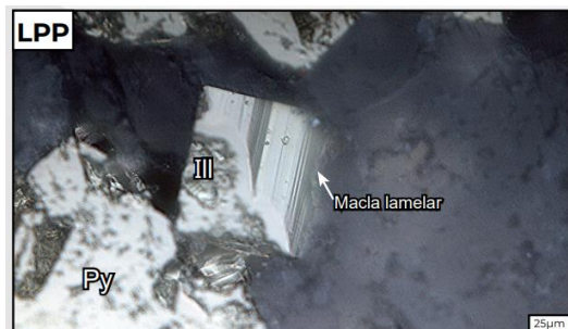
Figura 38. Cristal cúbico de ilmenita (Ill) con macla lamelar, se aprecian cristales de pirita (Py). Tamaño 25 um
