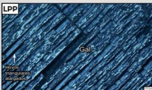
Descripción: Cristal de galena en donde se aprecia completamente su clivaje con hoyos triangulares alargados.
