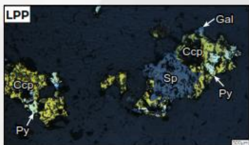
Descripción: Cristales de esfalerita, pirita, calcopirita y galena. Se puede apreciar que el mineral principal es la esfalerita.
