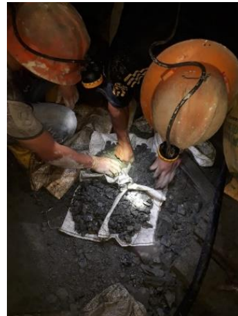
Figura 6. Homogenizando y cuarteando la muestra.
