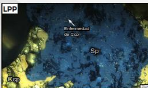
Descripción: Misma sección con mayor aumento. Se observa la enfermedad de calcopirita, típica textura observada en esfalerita.
