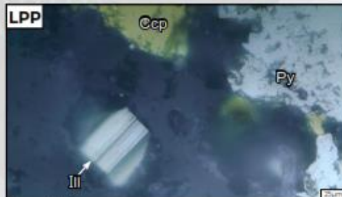
Descripción: Cristal cúbico de ilmenita con macla lamelar, se aprecian cristales de pirita y calcopirita.
