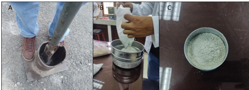
Figura 38. A) Pulverización de muestras. B) Tamizado malla #200. C) Material pasante malla #200.
