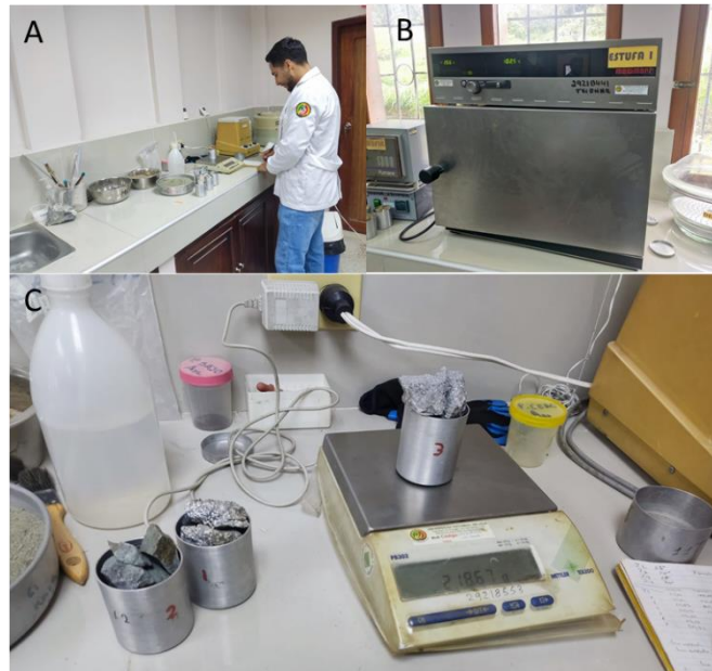
Figura 35. A) Toma de datos. B) Horno C) Peso de muestras secas.
