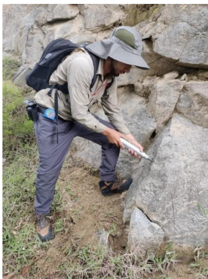
Figura 32. Aplicación del ensayo de esclerometría de bajo impacto.
