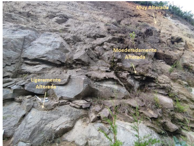
Figura 29. Meteorización de diaclasas
