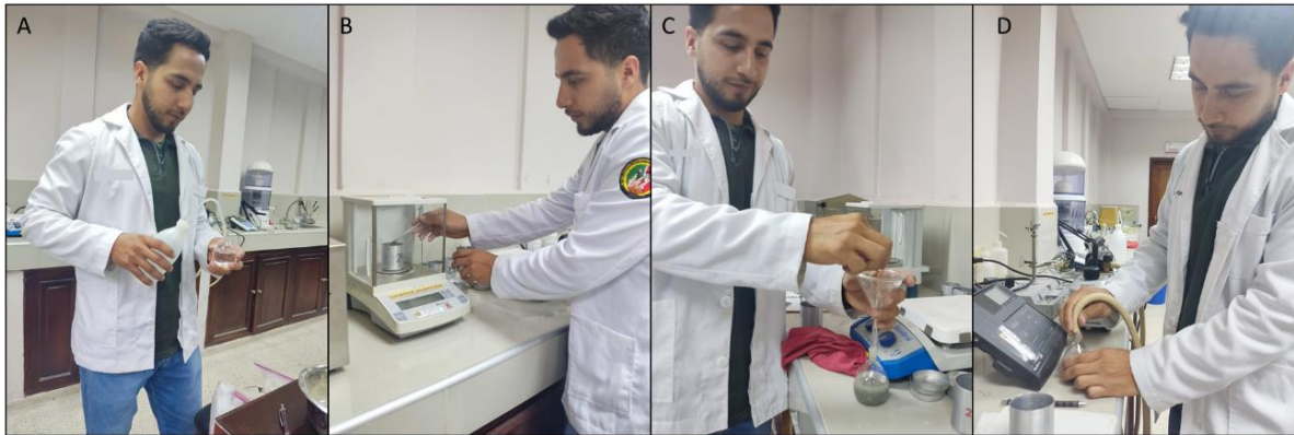
Figura 39. A) Agua destilada en picnómetro. B) Peso de 50 gr de material. C) Material en picnómetro. D) Eliminación de burbujas
