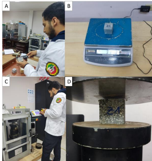
Figura 33. A) Medida de las aristas B) Peso de las muestras cubicas C) Prensa para ensayos de compresión simple. D) Ejecución del ensayo aplicado a probeta cubicas.
