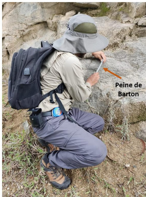
Figura 28. Medida de rugosidad mediante peine de Barton
