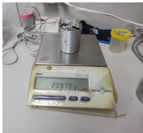
Figura 34. Determinación del peso natural.
