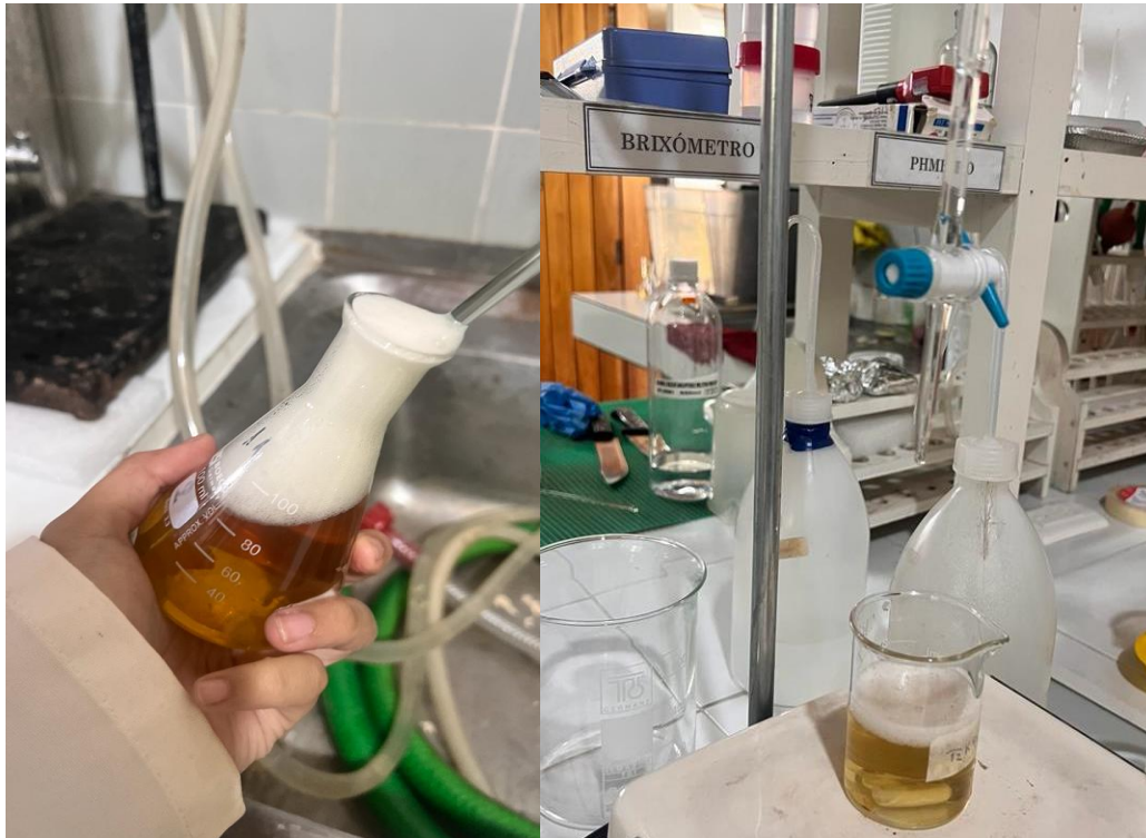
Anexo 14. Desgasificación para la determinación de la acidez titulable en la cerveza de uvilla.
