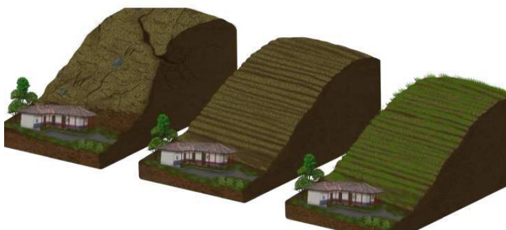
Figura 41. Revegetalización de taludes
