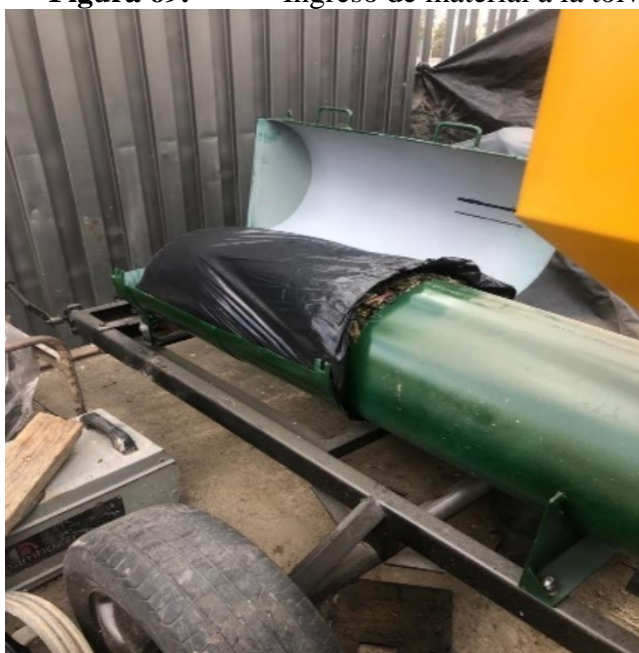
Figura 70. Compactado del pasto.
