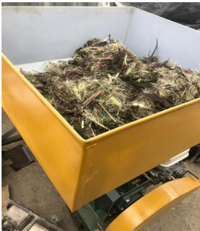
Figura 69. Ingreso de material a la tolva
