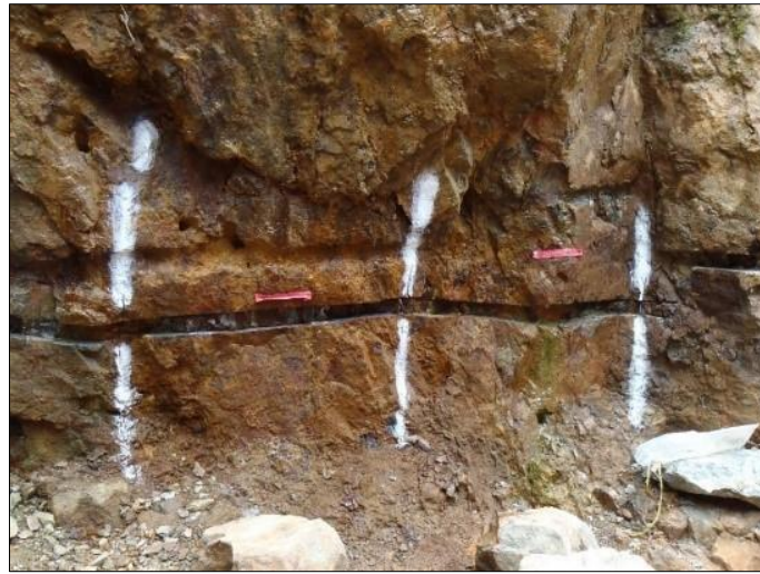
Figura 2. Muestreo ranurado continuo
