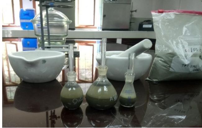
Figura 26. Determinación densidad y peso específico por el método del picnómetro
