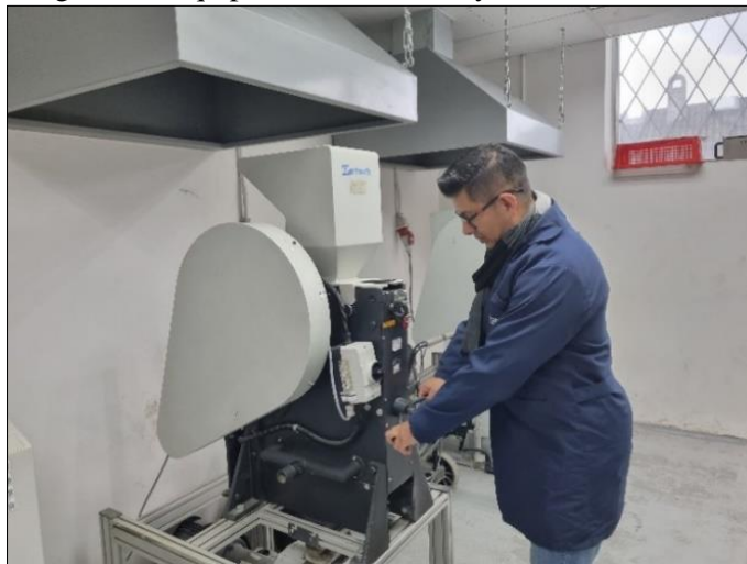
Figura 23. Equipos de Trituración y molienda
