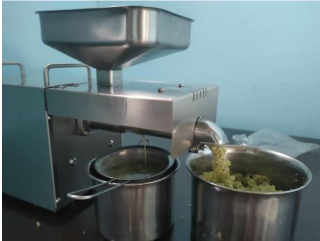
Figura 12. Prensado de la semilla.
