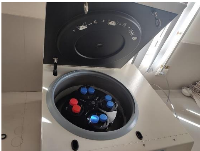
Figura 13. Centrifugado del aceite.
