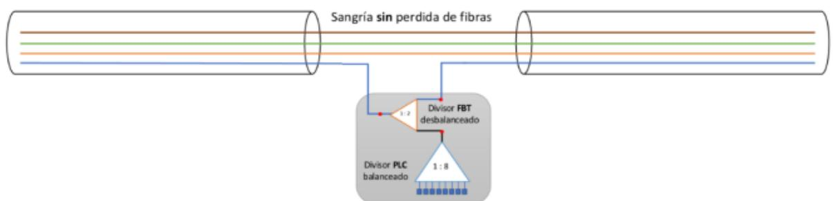
Figura 2: Representación de la conectorización de un splitter desbalanceado [9]
