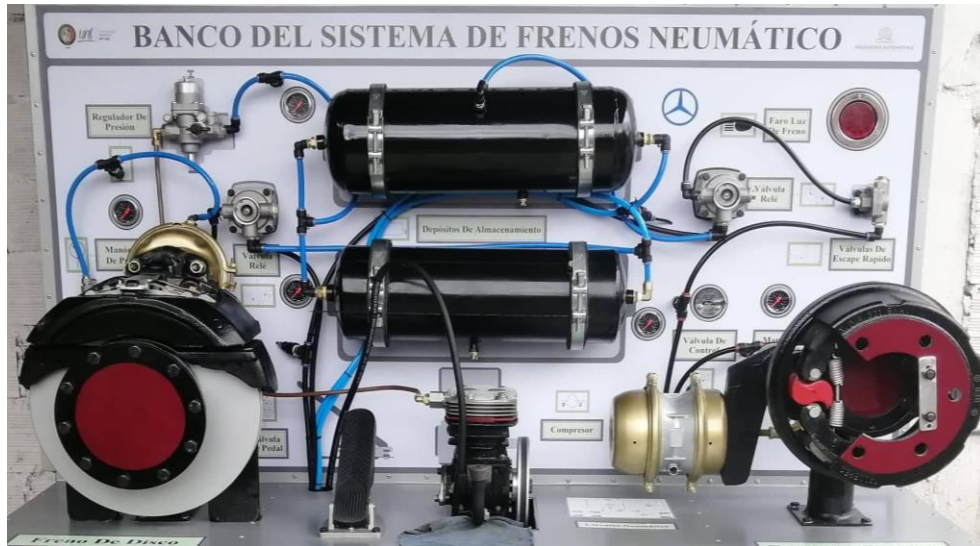
Figura 1. Esquema del sistema de frenos neumáticos.
