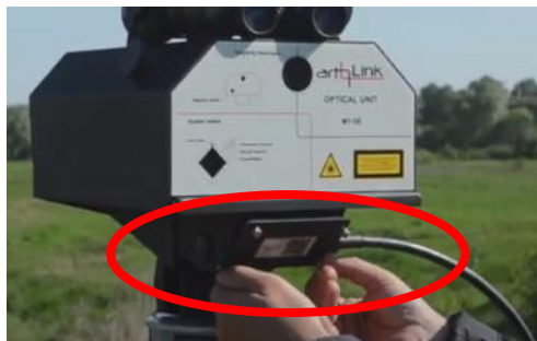
Figura 36. Tapa de compartimiento del equipo FSO
