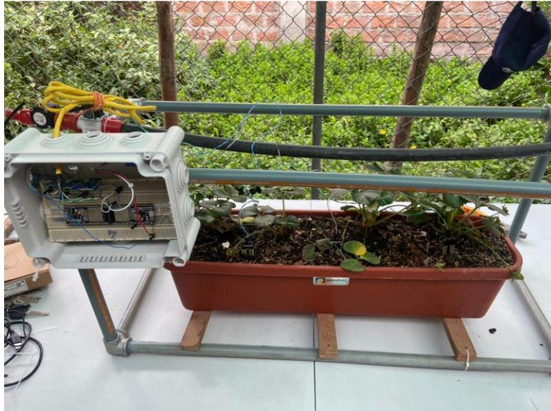
**Figura 61.** Estructura de prototipo final del sistema de irrigación
