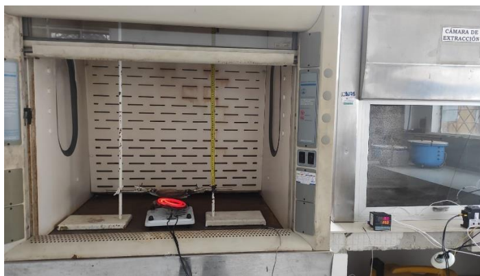
Figura 2. Epirradiador utilizado para determinar la inflamabilidad de los combustibles forestales muertos
