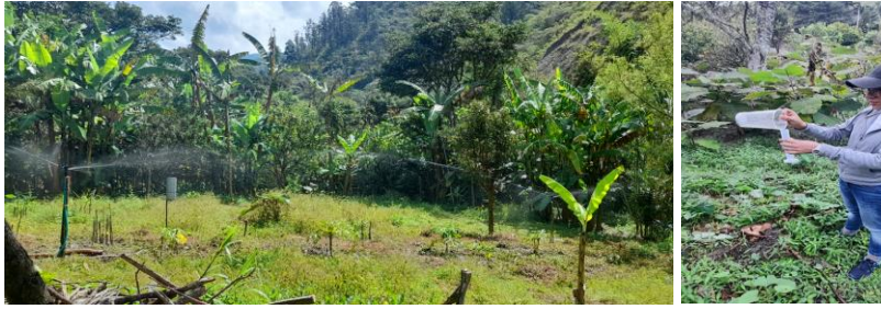
Figura 14. Realización de la prueba de uniformidad
