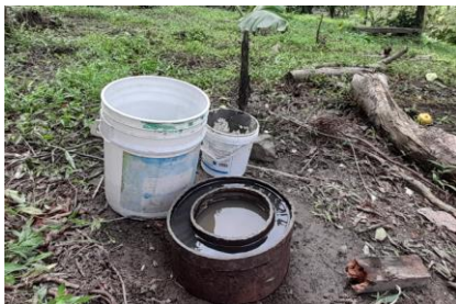
Figura 12. Pruebas de infiltración.
