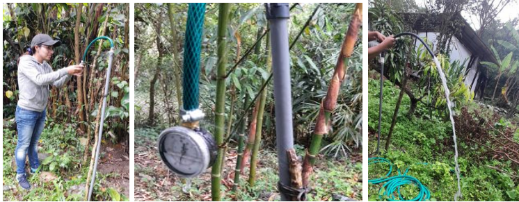
Figura 15. Determinación de la presión y aforo de los aspersores
