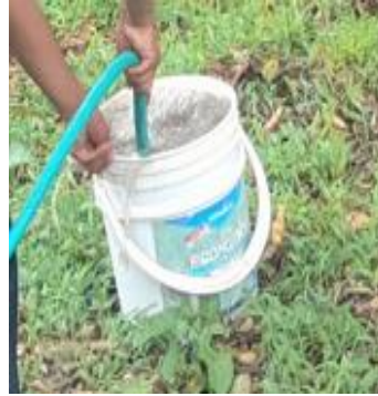
Figura 17. Aforo del caudal disponible en el predio
